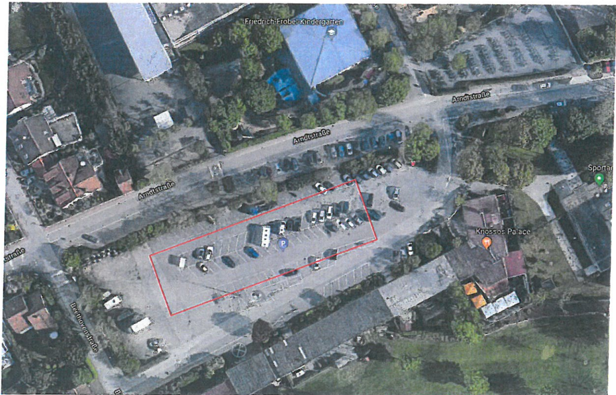
Fläche für Containeraufstellung und Auslagerung der Gustav-Lesemann-Schule | Fläche ca. 20 x 70 m Containeraufstellung 2-geschossig
